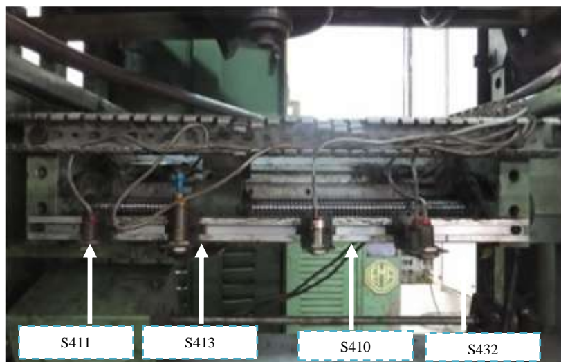
Figure 3. Capteurs associés à la retordeuse
