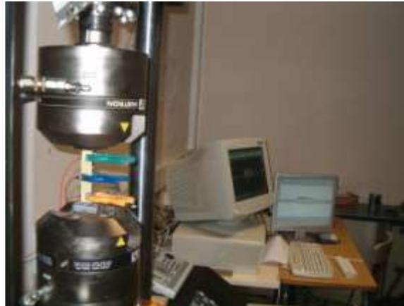
Figure 1. Machine de fatigue et système d'acquisition acoustique
