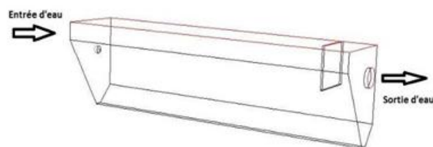
Figure 1. Modèle réduit du bassin à l'échelle 1/20.
