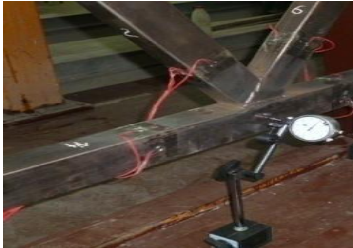
Figure.34 : Enregistrement du déplacement latéral
