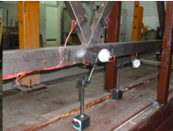
Figure 6 : comparateurs mécaniques de mesure de la flèche
