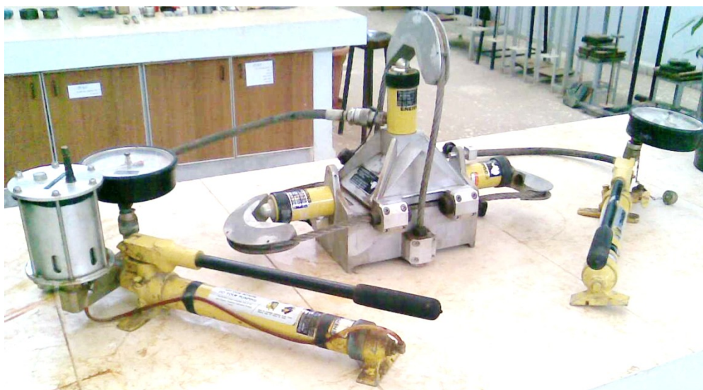
الشكل (3): جهاز هوك لقص الصخور في مختبر جامعة البعث - حمص (2014)
