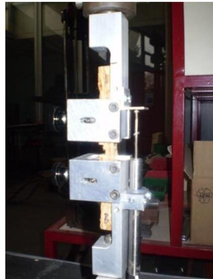
Figure 5 : dispositif du cisaillement roulant
