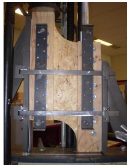
Figure 7 : dispositif du cisaillement de voile
