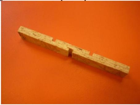
Figure 8 : éprouvette de cisaillement roulant avant rupture
