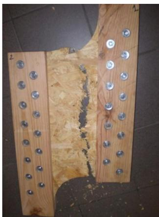
Figure 10 : exemple d'une éprouvette rompue en cisaillement de voile
