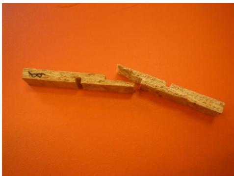
Figure 9 : exemple de rupture en cisaillement roulant
