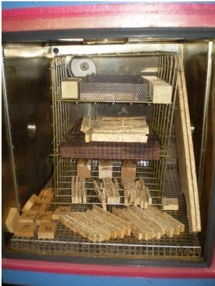
Figure 3 : conditionnement au four
