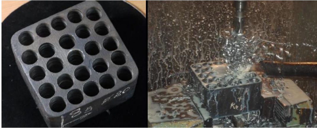
Figure 2: Éprouvette d'essais et illustration d'une opération de perçage.
