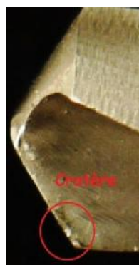
Figure 15 : Morphologie de l'usure sur la surface d'attaque
