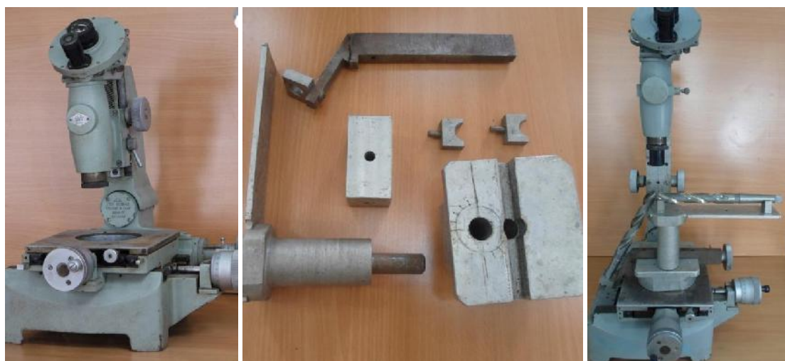
Figure 4: Microscope et dispositif de positionnement des forets.
