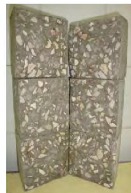
Figure 11. Eprouvettes sciées (absence de ségrégation)
