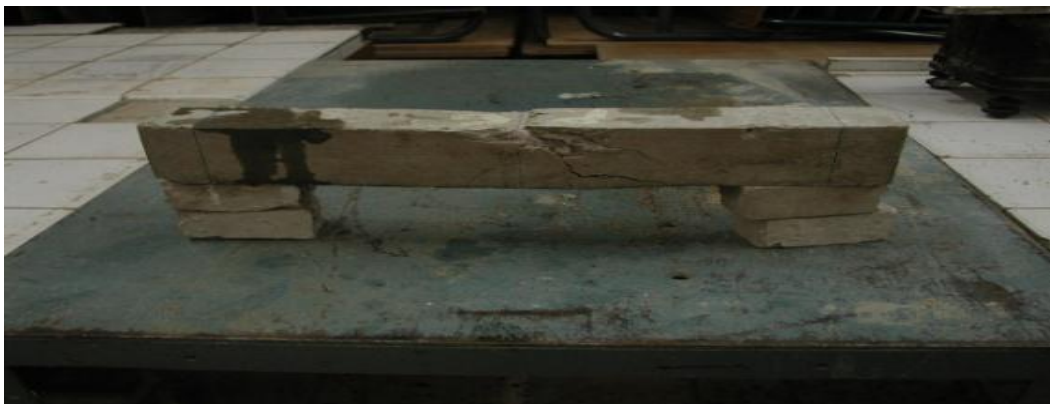
Figure 7. Rupture de la poutre P6
