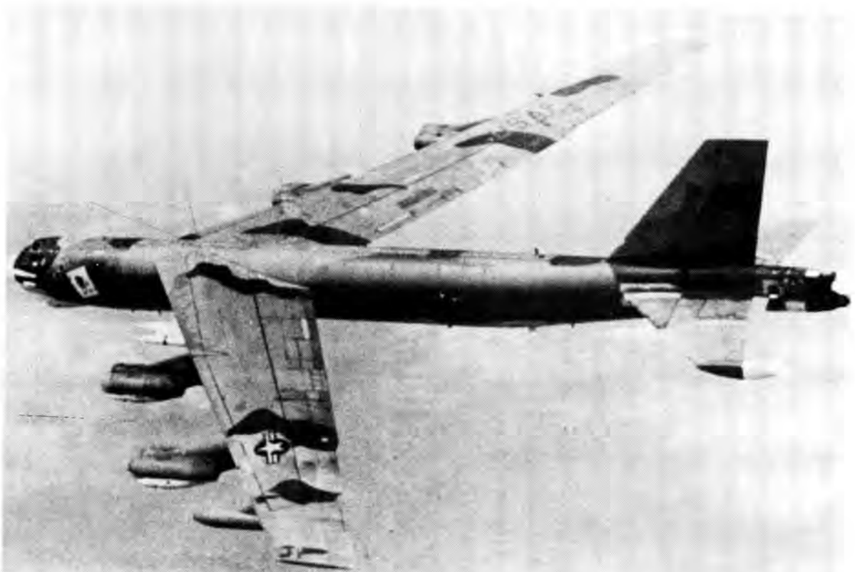
Boeing B-52G toegerus met 'n AN/ASQ 151 Elektro-Optiese Sigsteeem en ander onlangse modifikasies.
