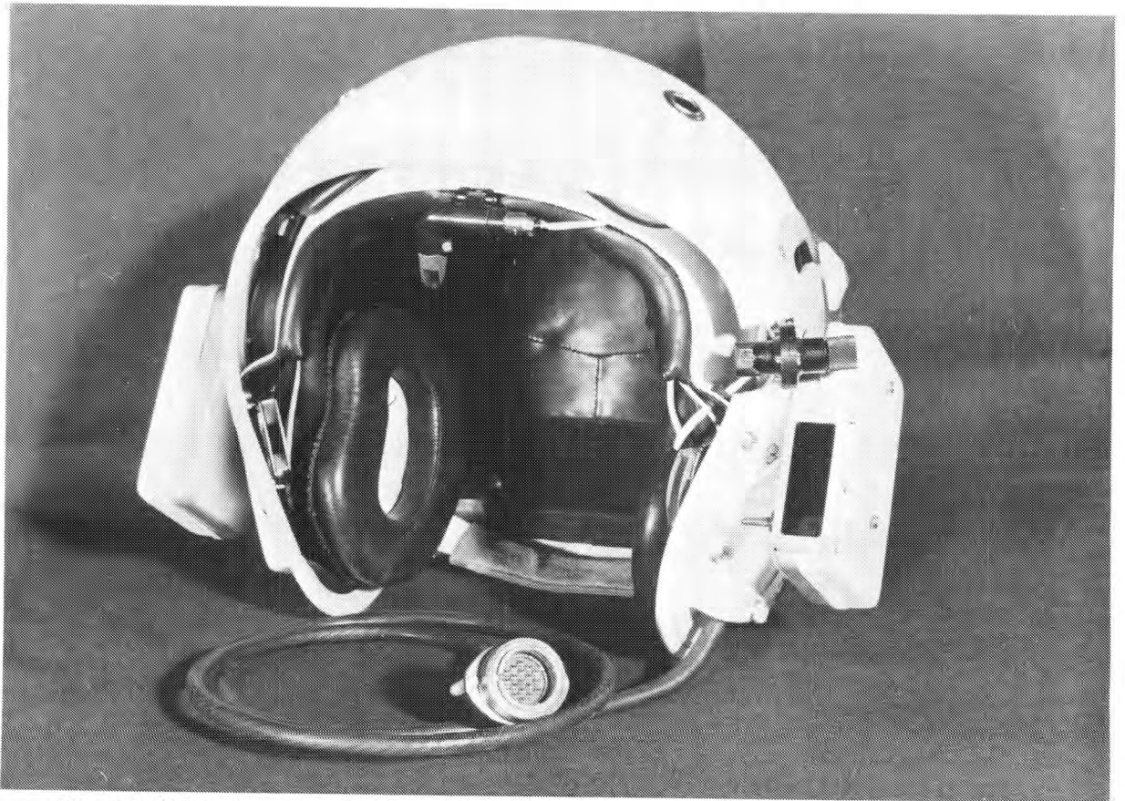
Die unieke Helmvisier aanwysstelsel vir die Kukri/V3 lug-tot-lug missiel wat ook 'n produk van Suid-Afrika is.
