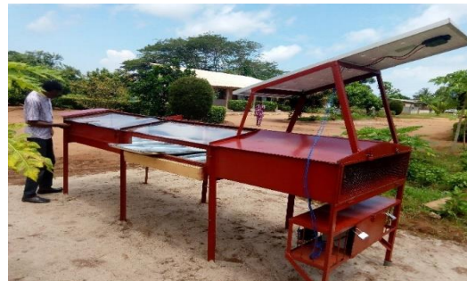
Figure 2. Photo d'un séchoir Hybride
