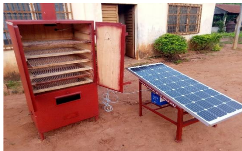
Figure 1. Photo d'un séchoir ATESTA muni d'un panneau solaire
