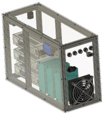
(d) Motor Control Box
