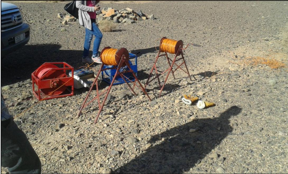
Fig.7 : Matériel utilisé pour les sondages électriques.
