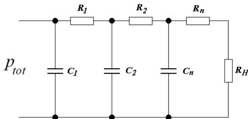
**Рис.1.** Обобщенный аналог конструкции светодиода.
