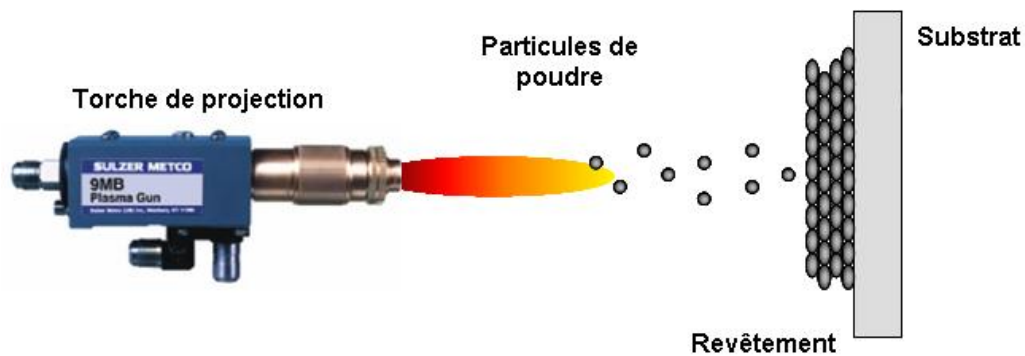
Fig.6. Schéma de principe de la projection thermique [3].
