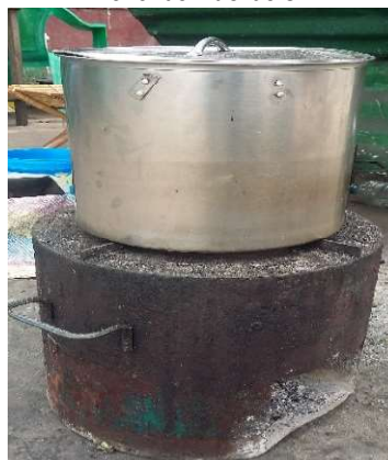
Photo 6 : Marmite posée sur un foyer amélioré à charbon de bois et à bois de cuisson
