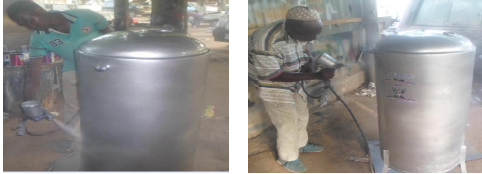
Planche 7 : finition par mise d'une couche de peinture, cliché (2016)
