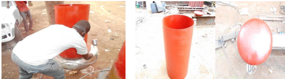
Planche 5 : étape de mise d'une couche d'antirouille, clichés (2016).
