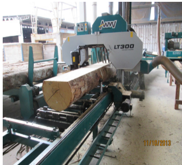
Figure 2 : Scie horizontale de marque "Wood Mizer" utilisée dans l'expérimentation
