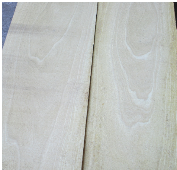
Figure 5 : Coloration blanc laiteux du bois de Fraké avec des figurations
