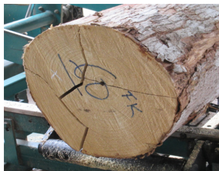
Figure 3 : Section d'un billon de Fraké avec des fentes et un cœur centré
