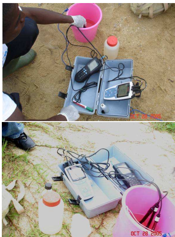
Figure 7 : Mesure in situ des paramètres physiques des eaux de la zone d'étude.
