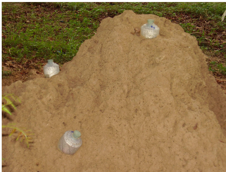
Figure 1: Dispositifs de piégeage de gaz sur une termitière de M. bellicosus .
