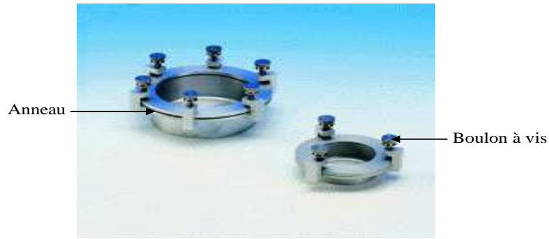
Figure 1: Coupe de perméabilité de Payne (modèle Elcometer 5100).
