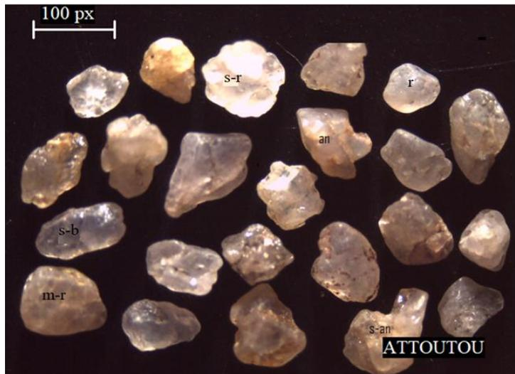
Figure 5 : Formes et aspects des grains de quartz (G : 640 µm × 480).
