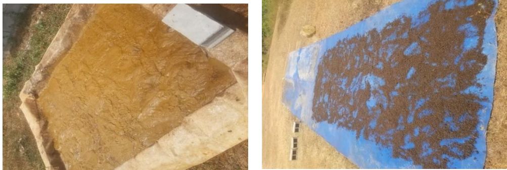
Figure 2 : Séchage de la boue d'huile de palme (à gauche état brut, à droite état sec).
