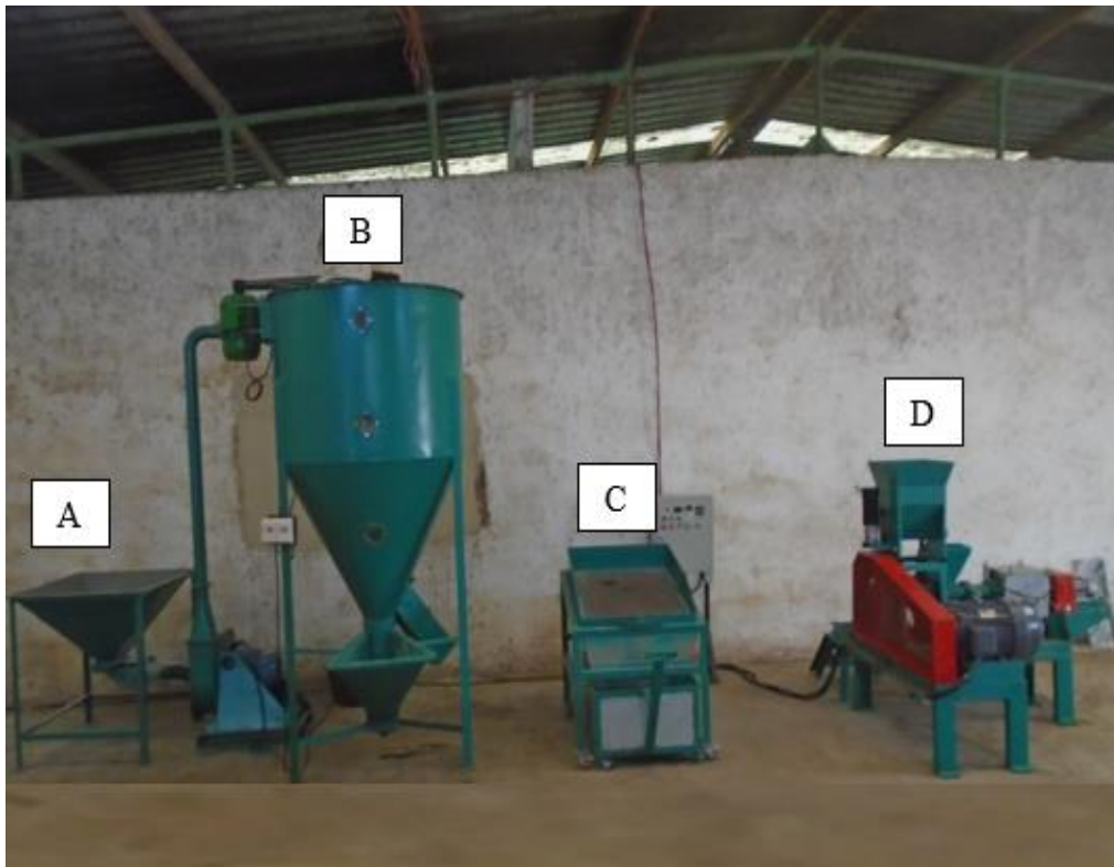
Figure 1 : Présentation de l'unité de production utilisée pour la mise au point des aliments locaux extrudés. A : broyeur (fabrication locale) ; B : Mélangeur (fabrication locale) ; C : Tamis (fabrication locale) ; D : Extrudeuse monovis (Henan Bedo Machinery DGP-80).
