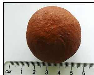
Fig. 5 Bauxite-PWS Composite Pellet
