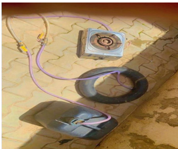
Figure 2: Fabricated mini bio-gas digester
