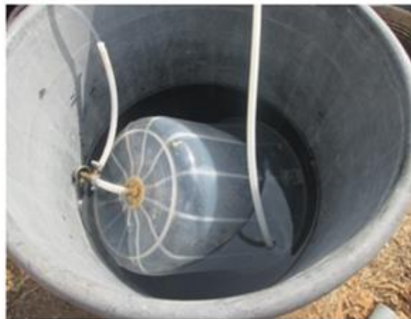
Plate 1: Actual Biogas Scrubbing System
