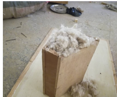
(d) Solar box's door cover filled with Kapok
