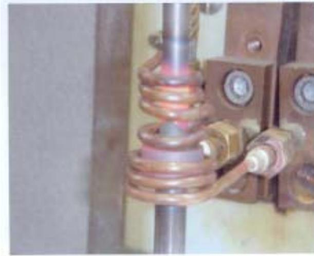
Figure 1: Procédé de chauffage superficiel par induction
