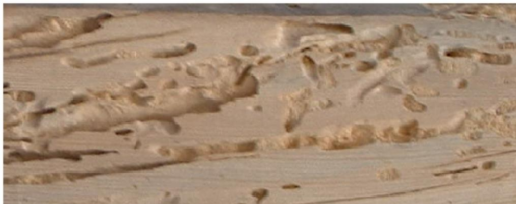
**Figure 3.** Damages of *H. bajulus* (L.).
