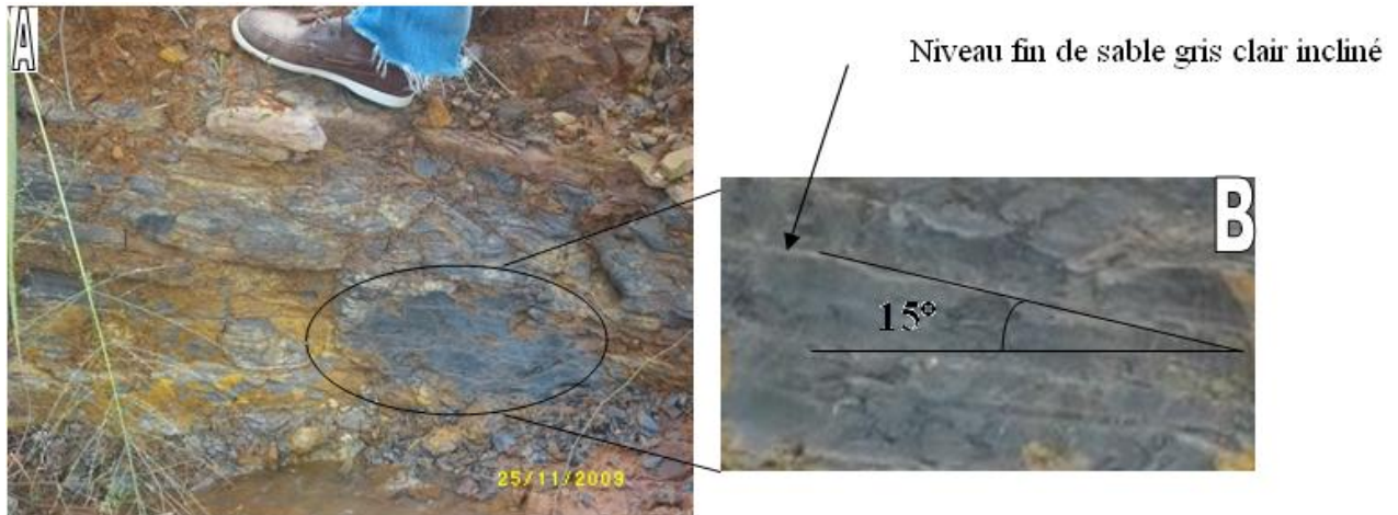
Photo 1 (A, B) : Argile noire avec de minces lits de sable fin gris clair incliné de 15^\circ
