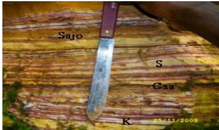
Photo 5 : Argile bariolée ( S: silt, Gsa: grésification de sable argileux jaune ocre, K: kaolinite)
