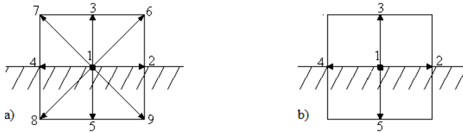
Figure 3 : Schéma du Lattice à la paroi a) D2Q9 et b) D2Q5
