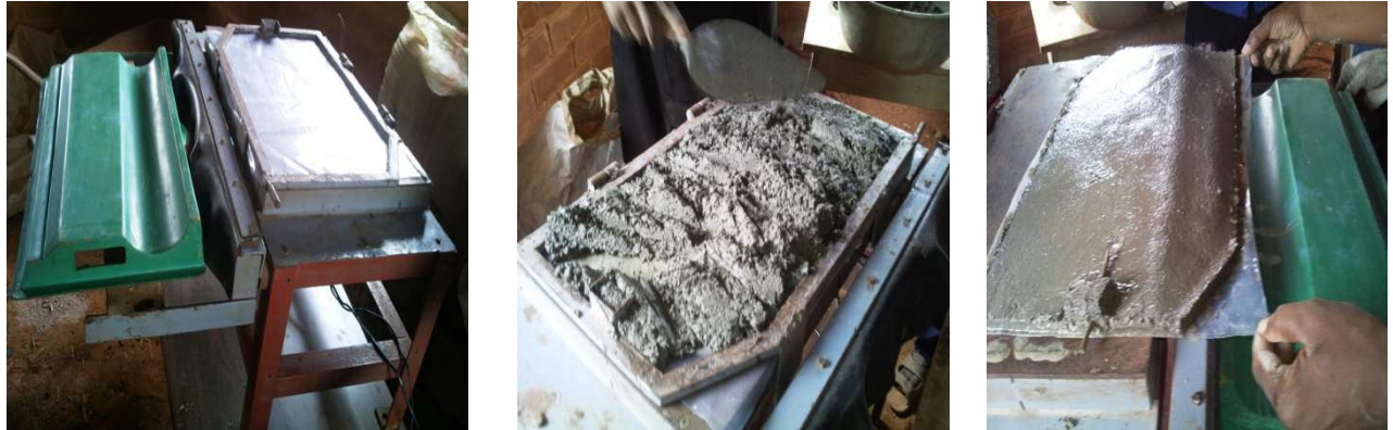
Figure 5 : Photos des moules, de la table vibrante et des tuiles d'expérimentation.
