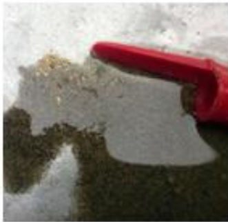
Etape 3 : Obtention du fond de Batée constitué des minéraux lourds (fond de batée)
