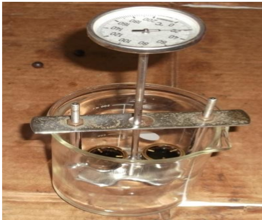
Figure 2 : Dispositif standard de mesure de ramollissement à bille et anneau
