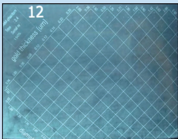
Fig. 2. CDMAM Superflab phantom image.
